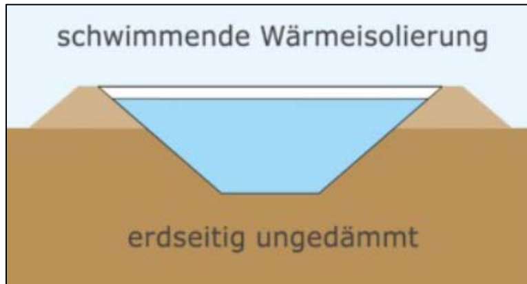
Abb. 5: Skizze eines Grubenspeichers (Quelle: www.solarwaerme-bracht.de/technik , Zugriffsdatum: 18.10.22)
