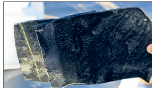
Die Kunststoffdichtungsbahnen werden in 4 Meter Breite überlappend verlegt und zweifach verschweißt. Sie sind nur wenige mm dick, aber außerordentlich stabil.
