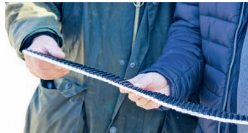
Das Vlies hat erdseitig ein Kunststoffgitter, um Steine abzufuffern, oberseitig eine Filzschicht.
